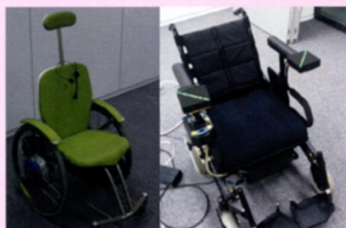
重度脳性マヒなどによりジョイスティックの使用が困難な方が、「音声の指令」により自立した移動を実現することを目標として、電動車いす用「音声入力装置」の研究開発を行いました。
