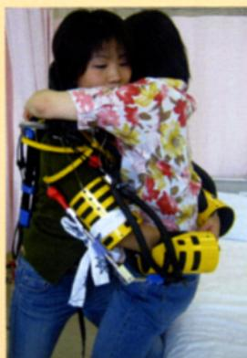
着用しても自由に動くことができる鎧のような構造物に、この空気圧式人工筋肉を取り付けることで、着用者を動かし、筋力を補助します。服のようにS・M・Lサイズを用意することで、ほとんどの人に適用することが可能であり、電気を使用していないため濡れても安全性には全く問題ありません。最終的には障害者や高齢者の自立支援を目指していますが、現時点では介護者などの肉体労働者の肉体的負担を軽減させることを目的に開発を進めています。
