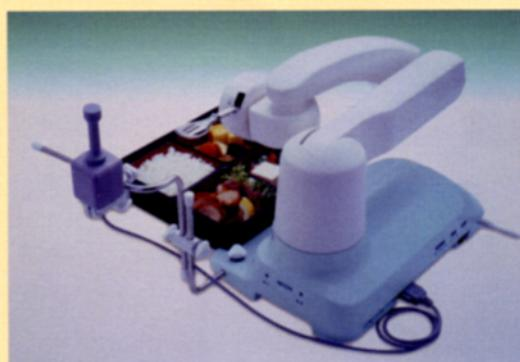
手の不自由な方が自分で食事を摂るためにロボットです。利用者のジョイスティック操作で、食事トレイの中の食物を口元まで運びます。専用のスプーン・フォークで、確実に食物をつかみ、食べる時にはフォークが格納されスプーンのみで食物を差し出すため食べ易くなっています。この機能により、ご飯、煮物、豆腐などほとんどのものが食べられます。体にフィットし易いように、3種類の操作装置（標準ジョイスティック、強化ジョイスティック、ボタンスイッチ）と3つの操作モード（食物のつかみ方を自在に選べる手動モード、簡単な操作でご飯かおかずかを選べる半自動モード、ボタンスイッチを押す度に食物を順番に食べられる自動モード）を用意しました。（社福）日本身体障害者団体連合会の「食事支援福祉機器助成事業」を利用した場合、販売価格（399,000円～）の9割が助成され、利用者は1割（約4万円）の負担で済みます。また日本とヨーロッパで販売中です。2006年、経済産業省の「今年のロボット大賞」において審査員特別賞を受賞しました。
